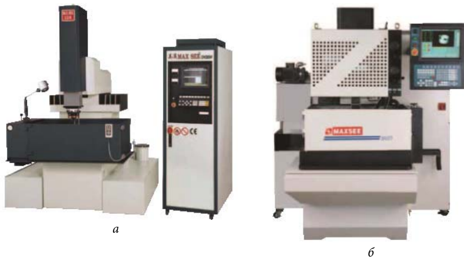
Рис. 3. Электроэрозионные станки: копировально-прошивной с подвижным столом (а) и проволочно-вырезной (струйного типа) с автоматической заправкой проволоки (б)
