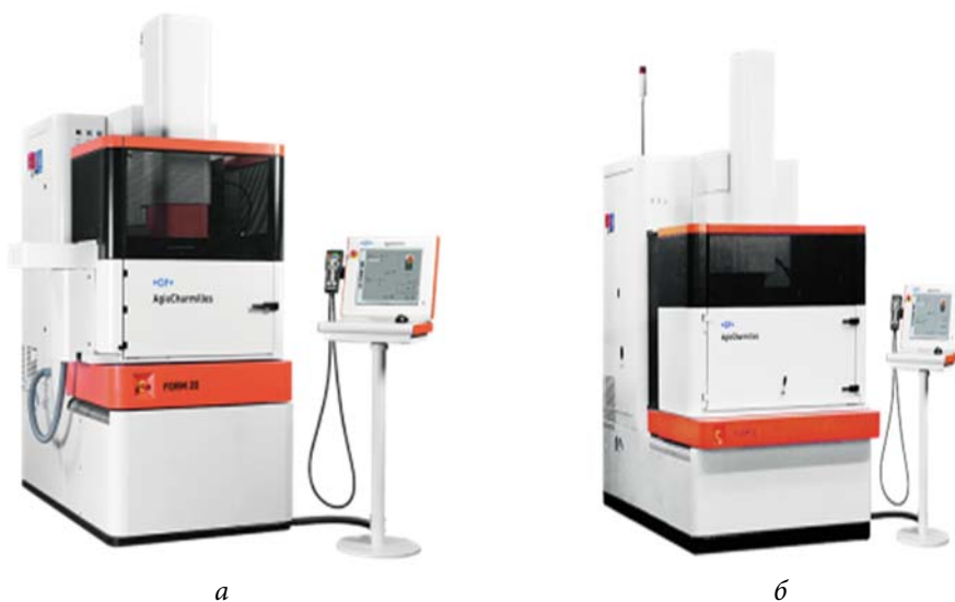
Рис. 2. Прошивной электроэрозионный станок общего назначения AGIE Charmille FORM20 (а) и AGIE Charmille FORM30 (б)
