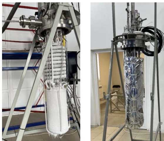
Рис. 3. Проведение приемо-сдаточных испытаний опытного образца ожижителя водорода
