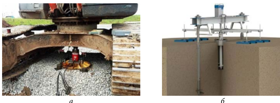
Рис. 1. Штамповые испытания: a — плоским штампом; б — винтовым штампом
