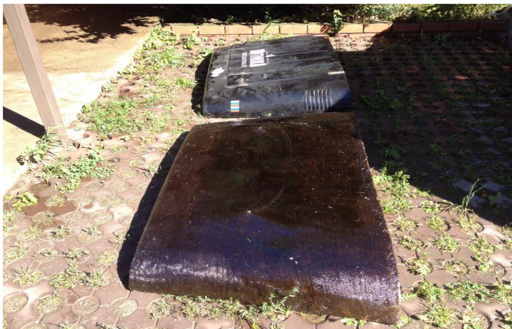
Капот автомобиля УАЗ-469, обработанный композиционным материалом на основе эпоксидной смолы ЭД-20 и стеклоровинга (на переднем плане)
