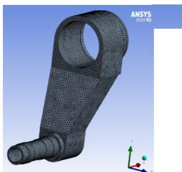
**Рис. 11.** Конечно-элементная модель балансира
