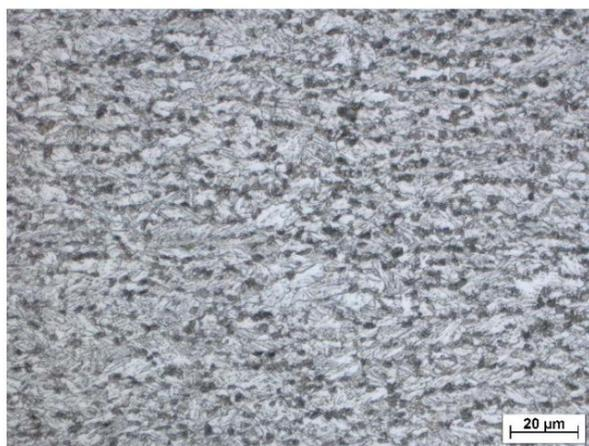
Рис. 2. Микроструктура стали SSAB 960MC
