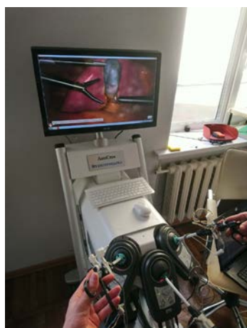
Рис. 11. Экспериментальное исследование рабочих зон хирургических инструментов на лапароскопическом тренажере
