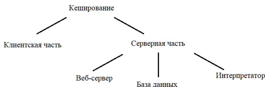
Рис. 3. Примерная схема кэширования веб-приложения [7]
