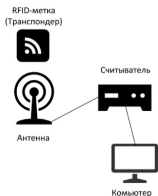
Рис. 2. Пример организации устройства RFID-системы
