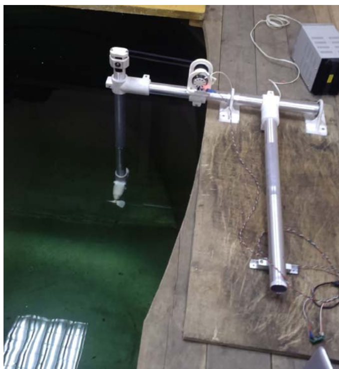
Рис. 4. Стенд для испытания гребных винтов, установленный в бассейне УНМЦ «Гидронавтика», на этапе наладки
