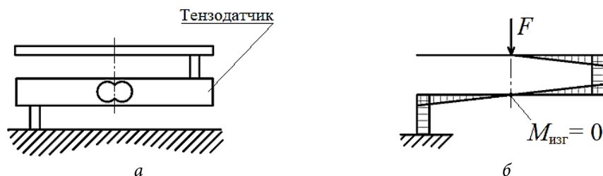
Рис. 5. Установка тензодатчиков упора и момента на стенде:
